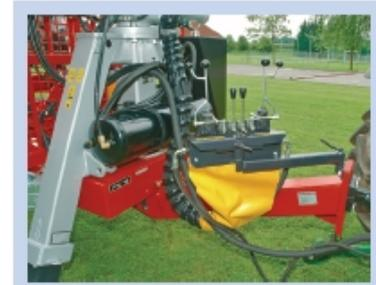
Die **hydraulischen Stützfüße** sorgen für eine hohe Standsicherheit. Durch die **innenliegenden Zylinder** kann es zu **keinen Beschädigungen** kommen. **Zylinderschutz**, **Unterlegkeile**, **stabiles Schutzgitter**, **Dreipunkt-Aufnahme** und **Eurosteuerung mit Halterung** **serienmäßig** (**Drehhebel-Steuerung** gegen Aufpreis).
