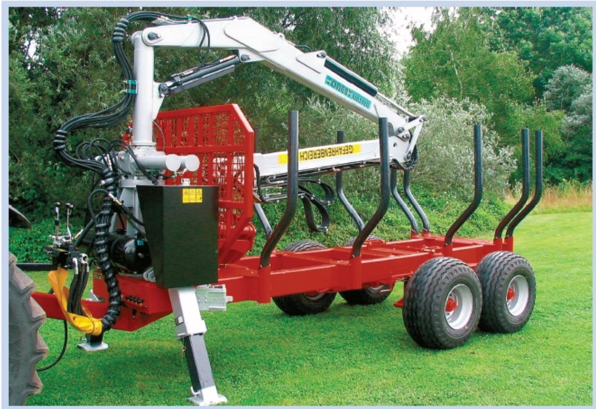
Der 14 to Hänger ist ein besonders stabiler Anhänger mit einem Doppelrahmen aus Hohlprofilen. Die Deichsellenkung mit 2 groß dimensionierten Zylindern sorgt für eine große Wendigkeit und gute Fahreigenschaften.
